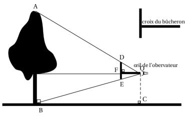
Il place la croix de sorte que 0, D et A d'une part et 0, E et B d'autre part soient alignés. Il sait que DE = 20 cm et OF = 35 cm. Il place [DE] verticalement et [OF] horizontalement. Il mesure au sol BC = 7.7 m.
